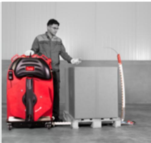
Auf der Rückseite wieder hoch, zurück in die Hand des Anwenders. Die **Kettenlanze** fährt wieder ein. Der **Bandheber** hebt das zweite Band.
