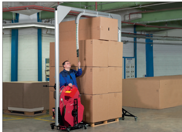
Mit dem mobilen Überhöhenmodul als Zusatzeinrichtung ist die Umreifung von Paletten bis zu 3 Meter Höhe möglich
