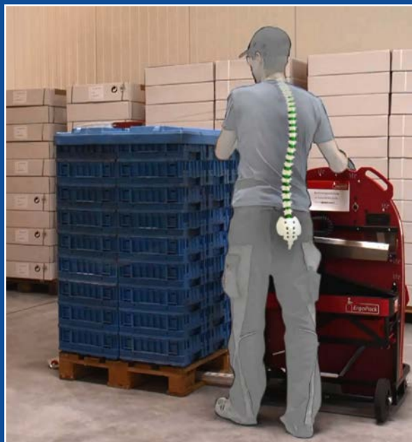
Wirbelsäulenbelastung bei der Umreifung von Paletten. Im Vergleich: Manuelle Umreifung mit Besenstiel und Umreifung mit einem ergonomischen Paletten-Umreifungssystem
